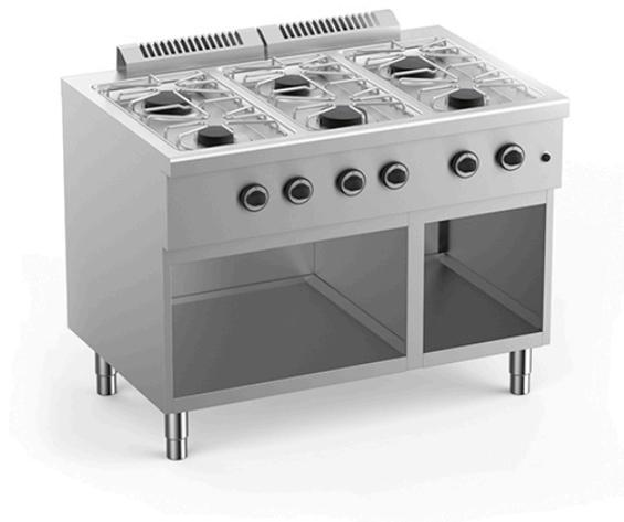
Estrutura externa e pés em aço inoxidável. Pés telescópicos. Superfície estampada em aço inox AISI 304 com cantos arredondados. Grelhas em aço inoxidável (grelhas em ferro fundido, sob pedido). Válvulas com sistema de segurança que interrompe o fornecimento do gás no caso de extinção da chama ou temperatura excessiva. Queimadores em ferro fundido esmaltado com chama auto-estabilizadora. Isqueiro elétrico.
