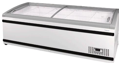
Revestimento externo em chapa pré pintada; revestimento interno em chapa plastificada; tampas de correr em vidro; espessura isolamento de 70 mm; termóstato digital; termómetro digital; bi-temperatura (refrigeração/congelamento); condensador ventilado; gás de refrigeração R290; paragolpes; caleira dreno da água, aparta águas; iluminação LED; ampla visibilidade; classe climática: 3L1.
