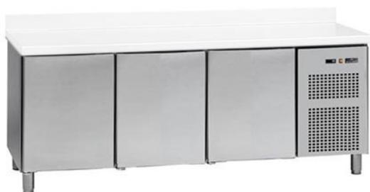
Interior e exterior em aço inoxidável, exceto painel posterior que é galvanizado. Ângulos, fundo e planos arredondados. Isolamento em poliuretano injetado com densidade 40 kg/m<sup>3</sup>, sem CFC. Frio ventilado. Controlo da temperatura com visor digital. Portas com dispositivo automático de fecho e fixação de abertura. Evaporação automática da água da condensação. Evaporador com tratamento anti-corrosão. Fundo com orifício para o escoamento de água. Pés em aço inoxidável reguláveis em altura.
