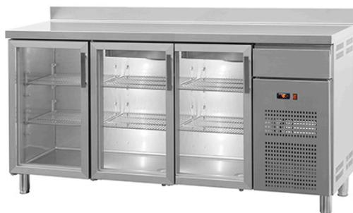
Interior y exterior en acero inox, excepto panel posterior en galvanizado. Ángulos y fondo redondeados. Aislamiento en poliuretano inyectado con densidad 40kg/m3, sin CFC. Frio ventilado. Puertas con dispositivo automático de cierre y fijación de apertura. Evaporación automática de agua de condensación. Evaporador con tratamiento anti-corrosión. Fondo con orificio para drenaje de agua. Pies regulables en altura. Control electrónico de la temperatura con visor digital. Descongelación automática.
