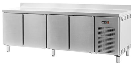
Interior y exterior en acero inox, excepto panel posterior en galvanizado; ángulos y fondo redondeados; aislamiento en poliuretano inyectado de 50 mm, densidad 40kg/m<sup>3</sup>, sin CFC; frío ventilado; termostato electrónico digital; puertas con dispositivo automático de cierre y fijación de apertura; evaporación automática de agua de condensación; evaporador con tratamiento anti-corrosión; fondo con orificio para drenaje de agua; pies regulables en altura.
