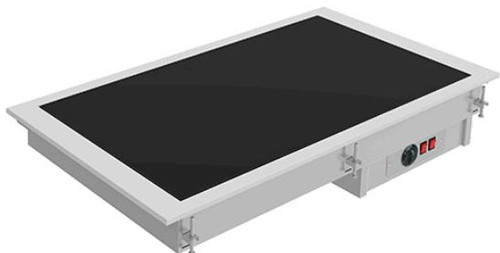
Placa lisa con sobre en cristal vitrocerámico para el servicio, presentación y mantenimiento de alimentos calientes. Sistema de calentamiento del cristal vitrocerámico mediante resistencias de silicona adheridas por su parte inferior que permiten obtener una temperatura regular en toda la superficie así como un ahorro de energía. Temperatura de trabajo de 30 °C a 120 °C regulable mediante termostato. Para otras posibilidades de instalación, dimensiones especiales, etc. se ruega consultar.
